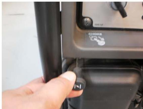
2. Coloque el interruptor del motor a la posición ON.
